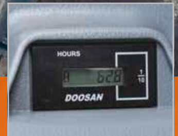
Betriebsstundenzähler (vom Boden aus ablesbar)
