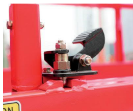
Pedalverriegelung des Plattformausschubs
